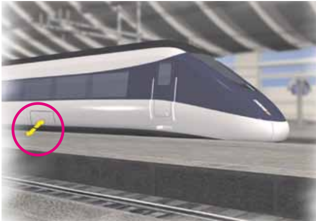
Batterieauszüge Battery chests
