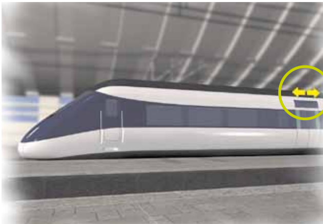
Schiebetüren außen External sliding doors
